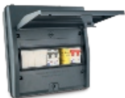
HPPO-07MG-A PRO65 7Way MS, B6&B20A RCBOs & SPD
